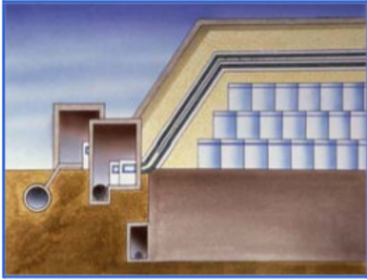
Abbildung 9: Schnitt durch das versiegelte Lager (IAEA 2005)
